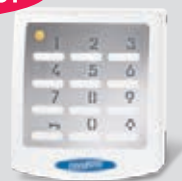
Funk-Codetaster Signal 218 10 Codes, 433 MHz, KeeLoq-Wechselcode mit Edelstahlblende, hinterleuchtet, aus UV-beständigem Material
