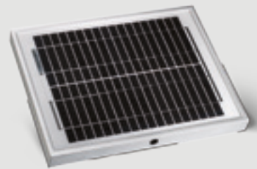
Solarmodul Leistung Pmax 10 Wp, Leerlaufspannung 21.5 V, Strom bei Pmax 0,5 A, Abmessungen 370 x 310 mm • Geeignet für: Novomatic 423 Accu
